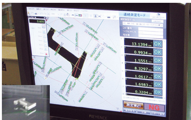
マキ電資の品質管理体制を支える、製品の計測装置の画面。細かい部品も（左下）、高い精度で瞬時に測定する。
