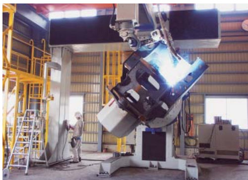
大型溶接ロボット
